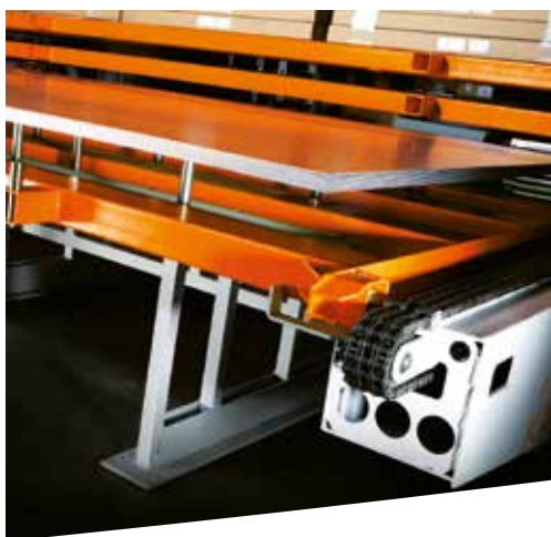
Stół ze specjalnymi kółkami umożliwiającymi depaletyzację i łatwiejszą obsługę (wyposażenie dodatkowe).
