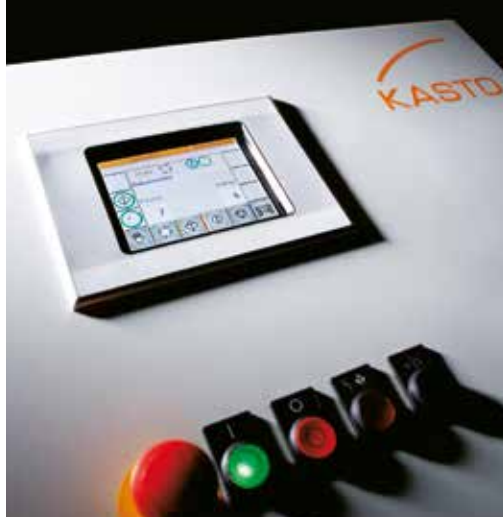
Kontrola składowania za pomocą wyboru gniazda i klawisza potwierdzającego.
