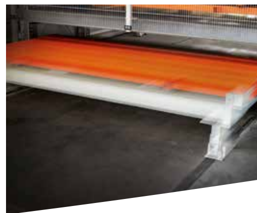
Manualnie przejezdny wózek do załadunku/rozładunku systemu od tylnej strony (opcja).
