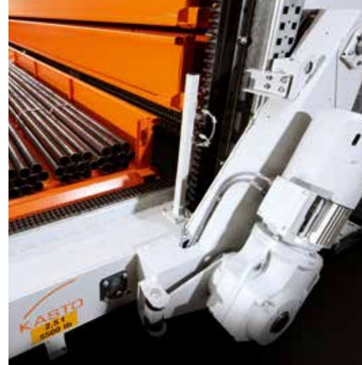
Winda z silnikiem oraz kasetą do składowania dłużyce.
