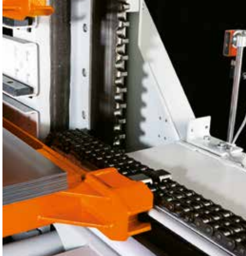
Winda i paleta do składowania blach oraz zębatką na regale, kontrola wysokości, jak również ślizgi pod palety.
